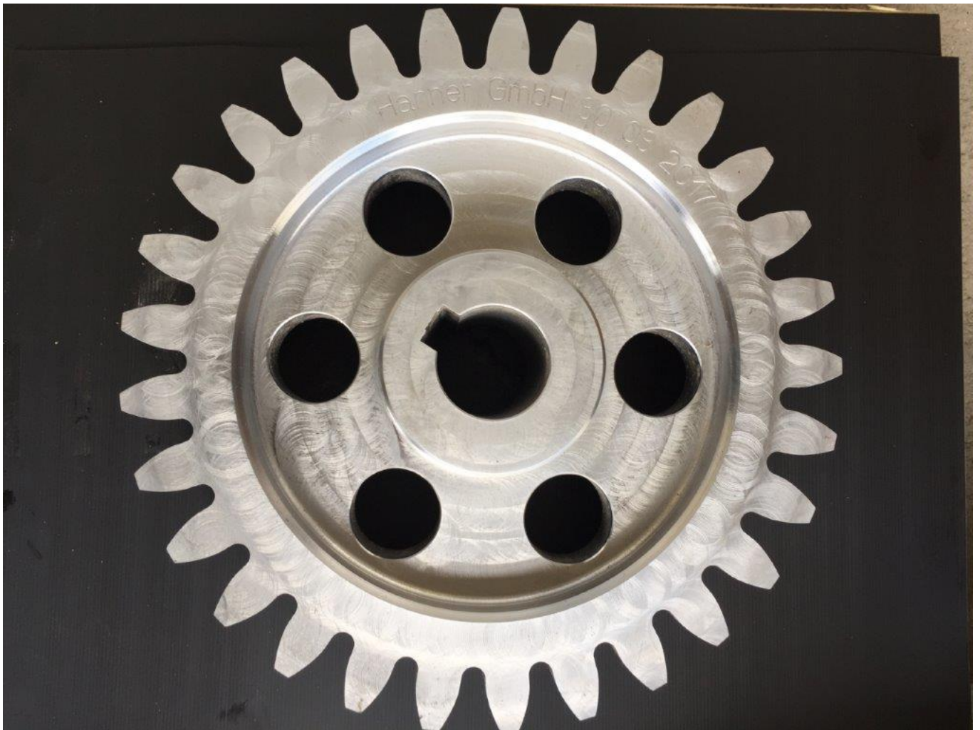
Zahnrad modul 16 / z 29 Dicke 155mm
