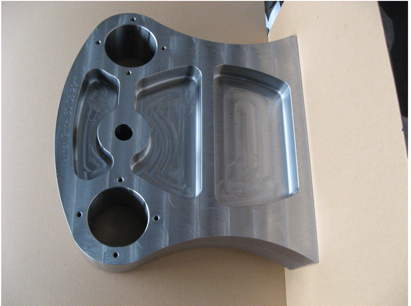
Stehlager aus St360 Dicke 116mm
